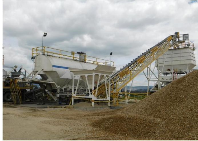
Continúan las adecuaciones mecánicas para el funcionamiento de la segunda planta de concretos, con la cual el Contratista garantizará el suministro y producción de concreto en la obra; esto permitirá reducir las emisiones atmosféricas generadas por el transporte de este material, que es fundamental para el desarrollo de las obras.
