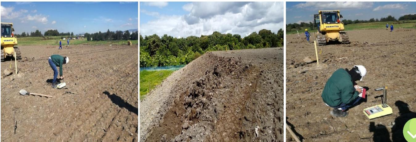
La conformación del terraplén ha finalizado 100%, se continua con el monitoreo de la instrumentación. En este lugar se continuará con el registro de las pruebas y ensayos, datos que posteriormente serán procesados y analizados, para interpretar el comportamiento del terreno y predecir su evolución frente a las cargas que deberá soportar la Ampliación y Optimización de la Planta.
