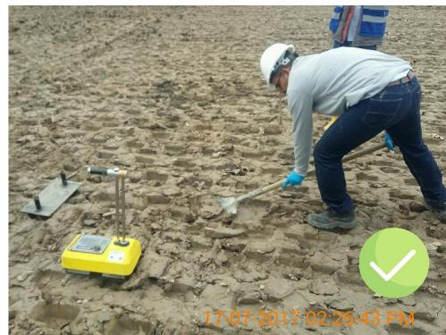
Esta actividad se encuentra en un **60%** de avance. Consistió en conformar y compactar un montículo de tierra con una altura de cinco (5) metros. En este lugar se continuará con el registro de las pruebas y ensayos, datos que posteriormente serán procesados y analizados, para interpretar el comportamiento del terreno y predecir su evolución frente a las cargas que deberá soportar la Ampliación y Optimización de la Planta.
